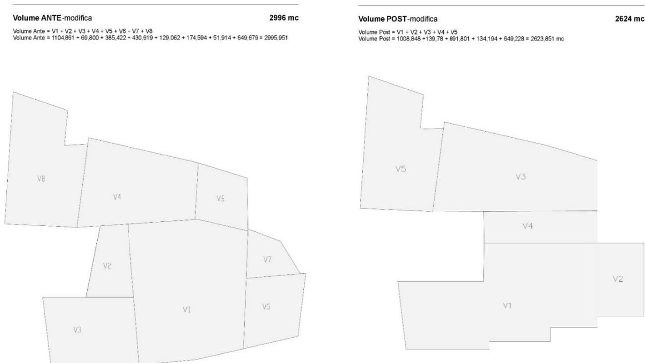
*Figura 12* Schemi di calcolo e calcoli delle volumetrie esistente e in progetto
